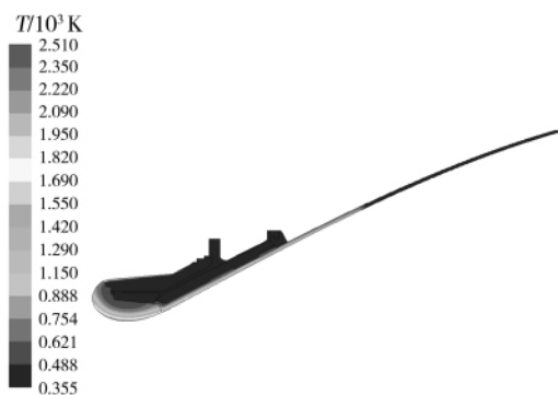
图 4 6 s 喷管温度场分布
