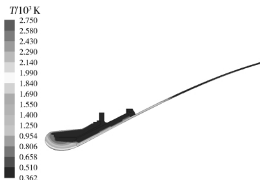
图 5 12 s 喷管温度场分布
